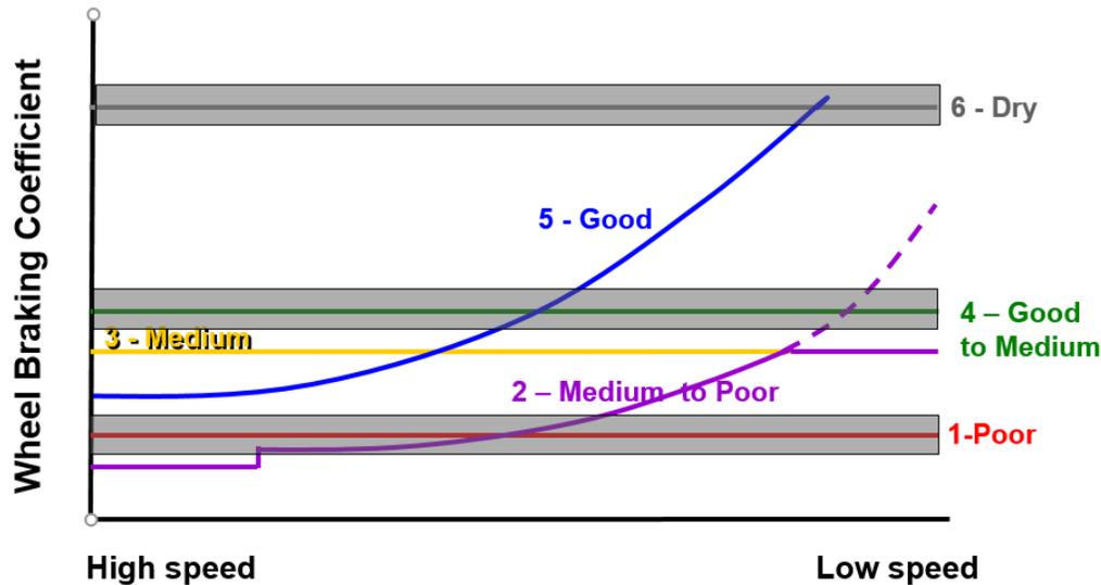
Figure 19 AC 25-32 Coefficient values (FAA)<sup>24</sup>
